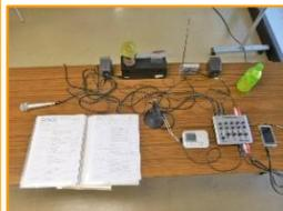
ミキサー(ラジオの心臓部)にマイク2本、ウォークマン(音源出し用)、ICレコーダー(番組録音用)、ミニスピーカー、写っていませんがFMトランスミッター(送信機)とエレキウクレレも接続。
